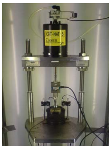
شکل ۱- نحوه بارگذاری در آزمایش تعیین تغییر شکل ماندگار [۲۰]
