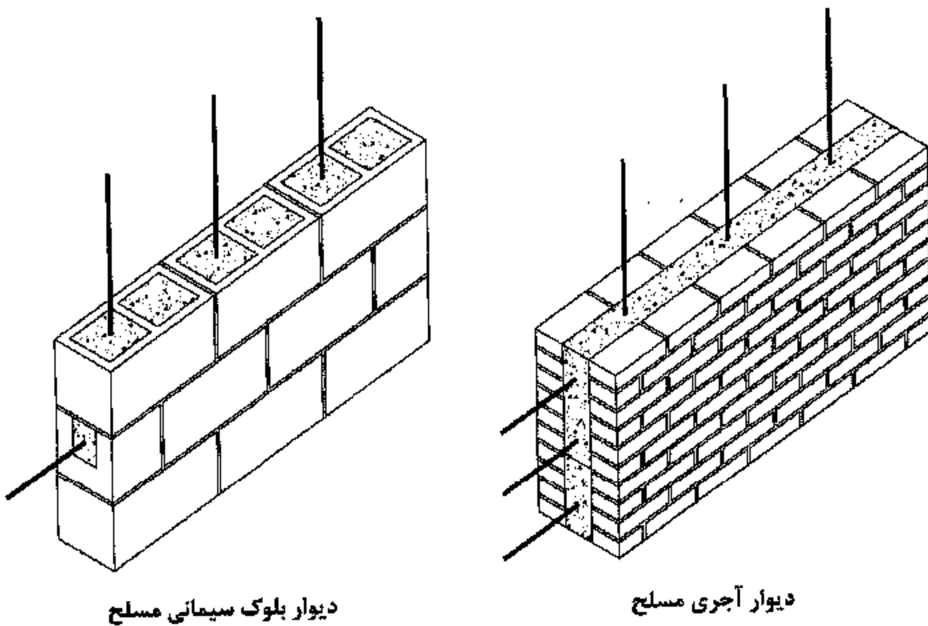
شکل ۴-۸ نمونه‌هایی از دیوارهای بنایی مسلح
